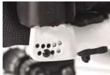
Nueva unión del respaldo soldada, con una robustez superior.
