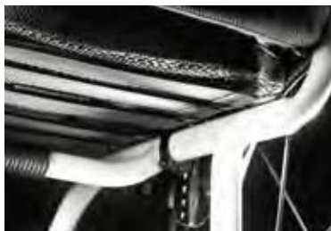
Nueva forma ovalada del tubo inferior del asiento. Sin flexiones
