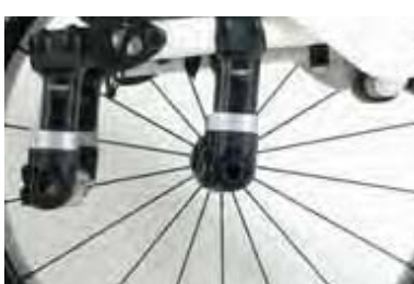
Eje para el acople de handbikes (opcional) que aumenta la estabilidad.
